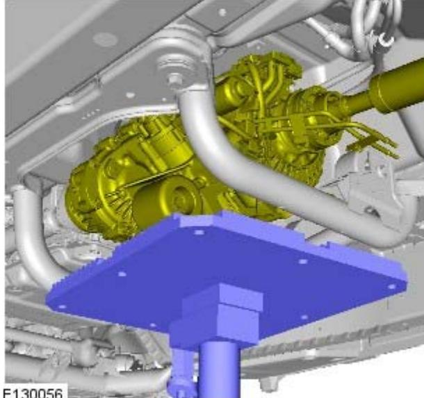
3. 卸下变速器支承绝缘体螺母、螺栓和减震器。
